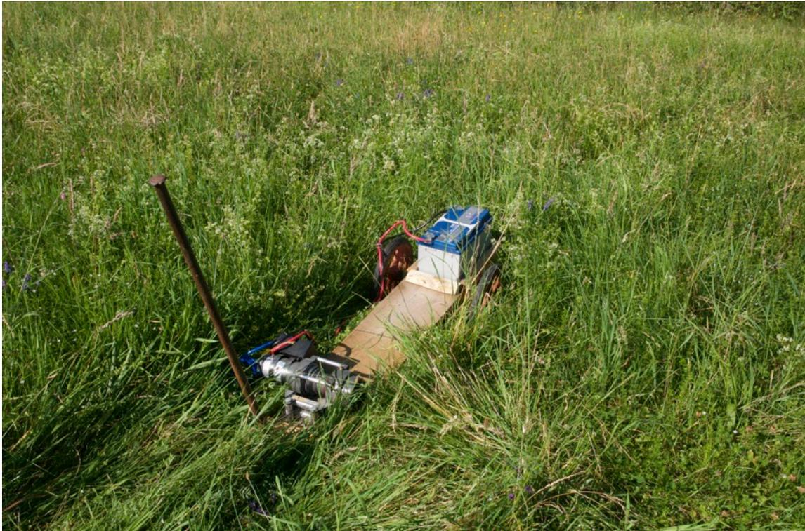
Abbildung 1: Quadseilwinde mit 12V Autobatterie
